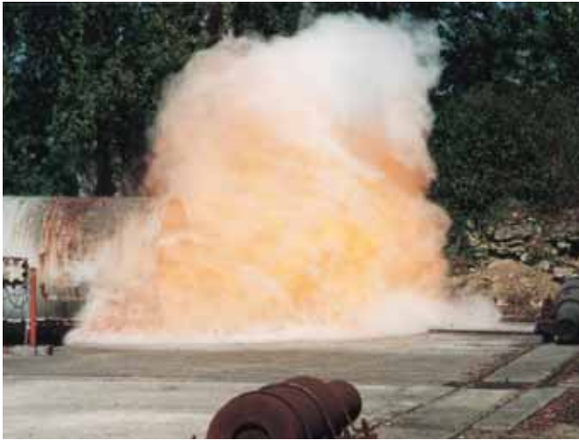
Photo 1.6 Explosion de poussières de farine (Source INÉRIIS)
