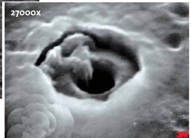
Photos 5.1 Dommages causés par les décharges électrostatiques sur les composants électroniques (Photos 3M)
