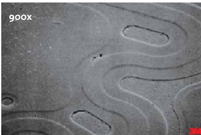
Photos 5.1 Dommages causés par les décharges électrostatiques sur les composants électroniques (Photos 3M)
