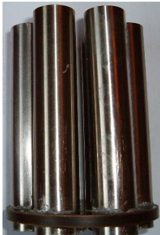
Tubes en Acier inoxydable 316L sans soudure :
