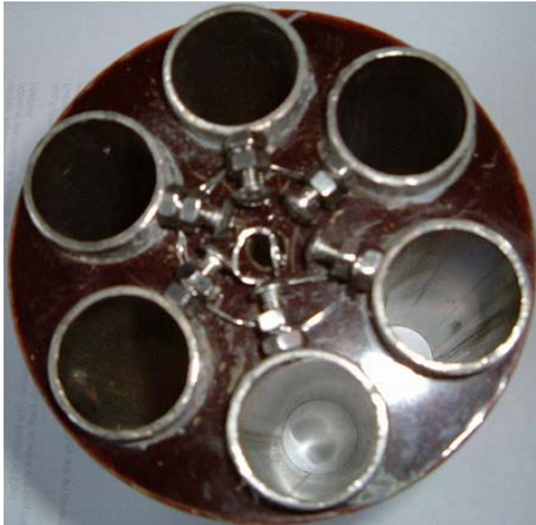
Les raccordements électriques des tubes se font par l'intermédiaire de fil en acier inoxydable fixés par les boulons en acier inoxydable.
