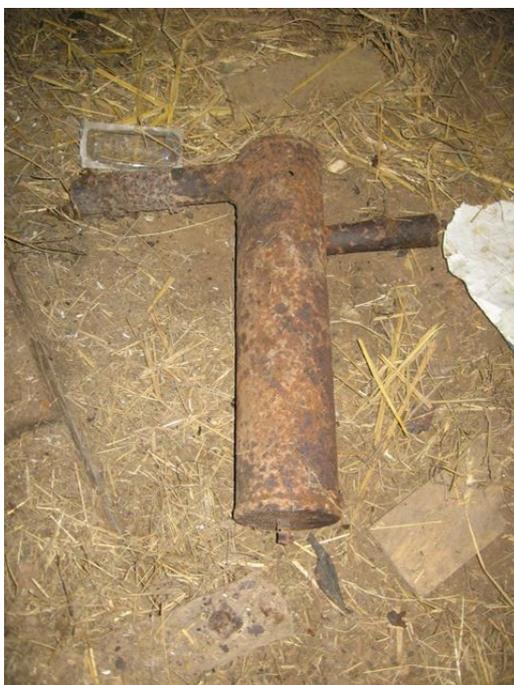
Il est vraisemblable que M. Gaston a supprimé le silencieux pour raccorder l'échappement à l'extérieur. Logique : au bout de deux heures de fonctionnement à l'essence dans un local confiné, l'air ne doit pas être très respirable !
