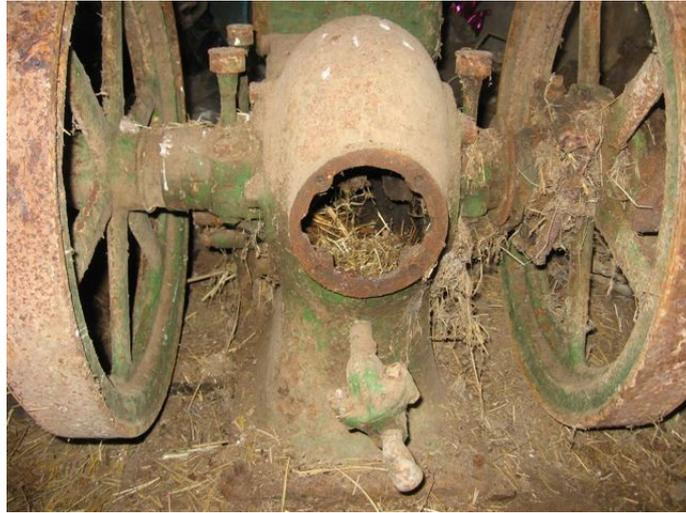
Le plus étonnant est peut-être ce gros robinet qui débouche sous l'embiellage : ce devrait être l'orifice de vidange d'huile. Ou pourquoi pas l'évacuation de l'eau condensée dans l'échappement ?
