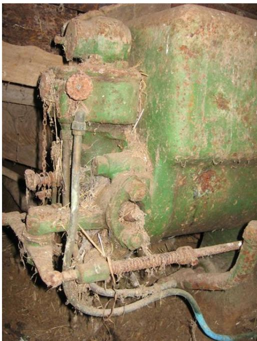
Au sommet on trouve aussi une espèce de « cloche » qui devrait constituer le filtre à air. Si le moteur utilise de la vapeur d'eau, le filtre est peut être sous-dimensionné en conséquence comme pour un montage « système G ».
