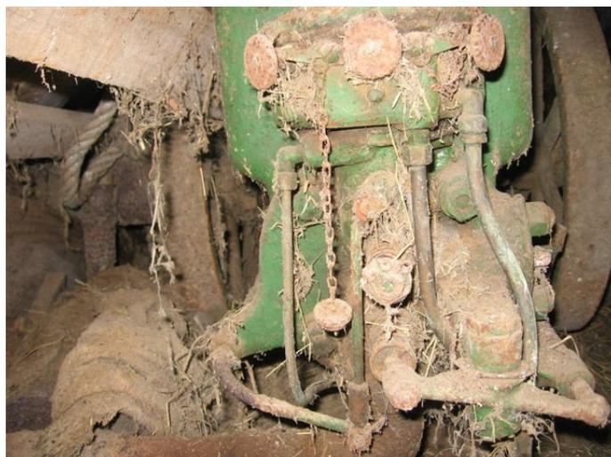
Le moteur peut être tourné à la main facilement, ce qui révèle un faible taux de compression. Mais pas de trace de fils, de bougie ou de magnéto. Il s'agirait plutôt d'un moteur de type diesel, à allumage par [faible ?] compression.
