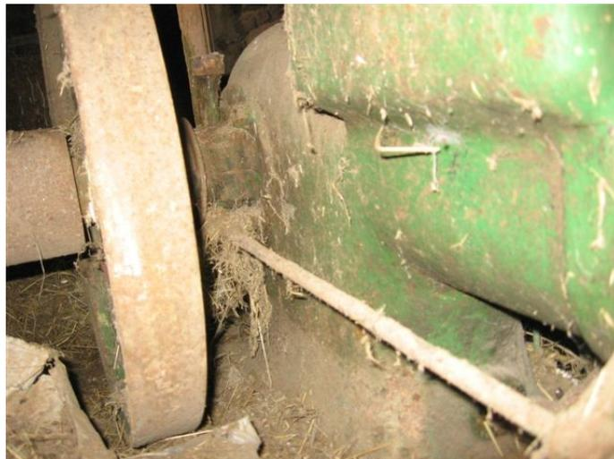
L'analyse des photos montre qu'il existe également une tige (que j'ai prise au départ pour une canalisation) du côté opposé au culbuteur. Elle s'avère faire partie d'un bras oscillant.
