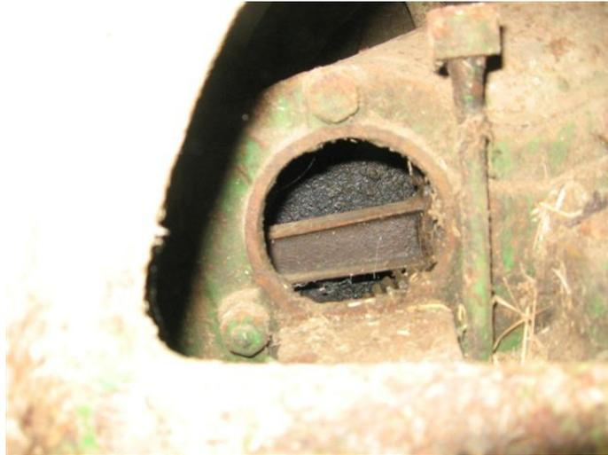
Les trappes de visite sont restées ouvertes : en écartant le foin on peut observer la bielle et un engrenage réducteur qui actionne un excentrique, lequel commande le culbuteur actionnant une unique soupape. Le rapport de réduction montre qu'il s'agit d'un moteur 4 temps.
