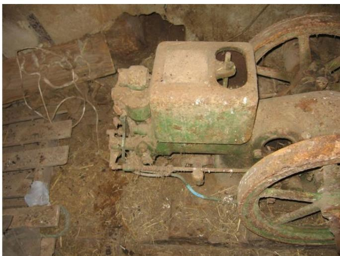
Le corps du moteur est en fonte épaisse, comme plusieurs des pièces observables. Vu du dessus, il fait penser à un petit canon dont le fût serait l'unique cylindre, et les roues constituées par le double volant d'inertie servant
