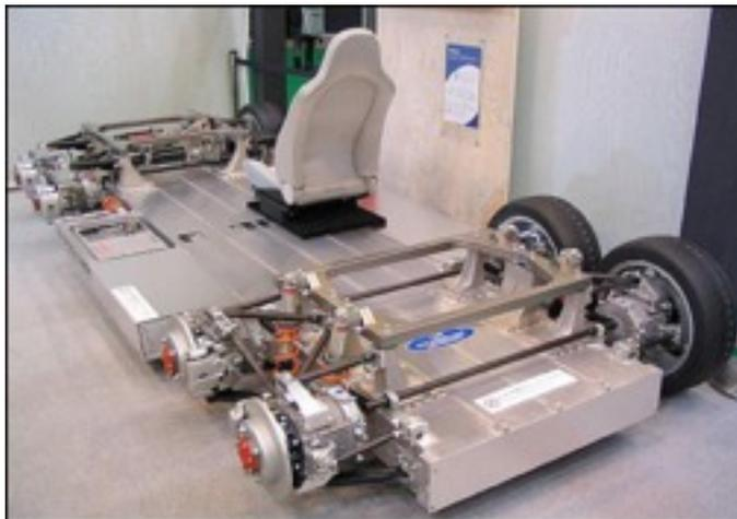
*La plate-forme de la Eliica contenant les batteries. On voit également les moteurs dans les roues*
