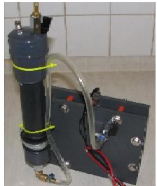
C'est donc après avoir reproduit l'électrolyseur de Mr Tero Ranta que nous avons évolué vers notre modèle suivant, qui était donc déjà en inox, mais qui comportait encore deux parties, les électrodes et le bulleur qui servait aussi de réservoir pour augmenter le volume d'électrolyte embarqué:
