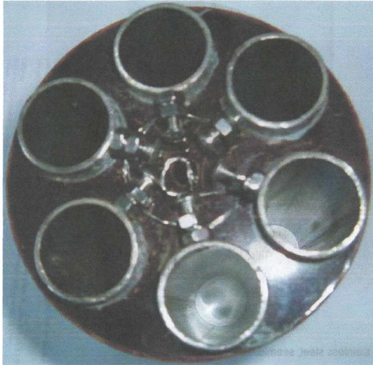
Les connexions électriques sont conduites par le fil d'acier inoxydable en cours d'exécution entre les boulons en acier inoxydable coulé dans les tuyaux et les boulons en acier inoxydable en cours d'exécution à travers la base de l'unité:
