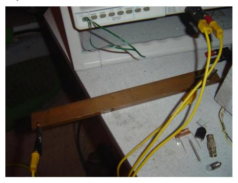
Le matériel est très simple : un barreau de cuivre de 5mm d'épaisseur d'une longueur de 20cm et 3 cm de large, du fil <u>non blindé</u> car un fil de mesure blindé avec une BNC, amène des parasites capacitifs. L'oscilloscope est un Metrix OX863B (<a href="http://fr.rs-online.com/web/p/oscilloscopes-analogiques/4271290/">http://fr.rs-online.com/web/p/oscilloscopes-analogiques/4271290/</a>).
