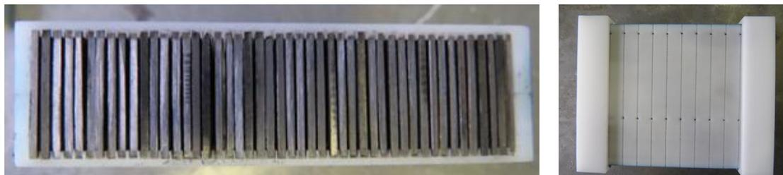
Figure 6 : Vues du prototype du régénérateur magnétique actif
