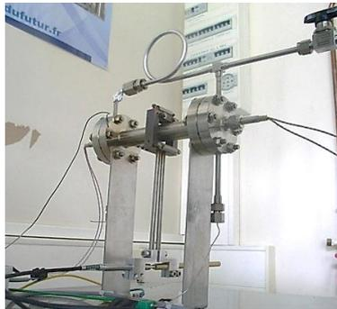
Figure 1 : Porte-échantillon et capteur LVDT
