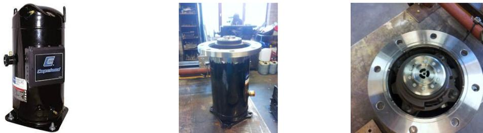
Figure 5 – Transformation d'un compresseur spirale (gauche) en turbine (droite)
