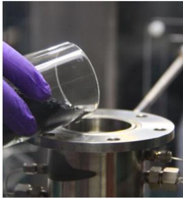
Figure 4 : introduction du catalyseur
