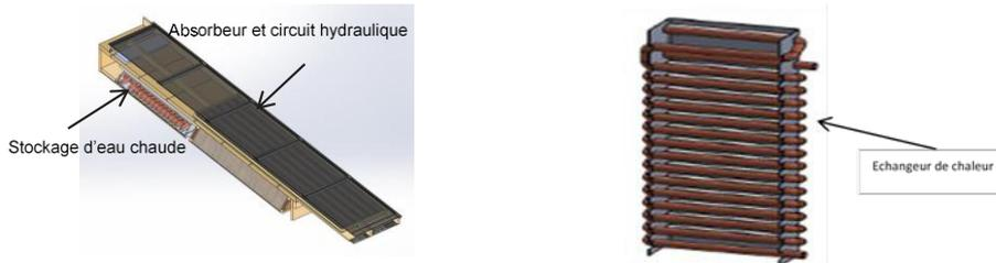
Figure 7 : coupe du caisson 3 et vue 3D de l'échangeur
