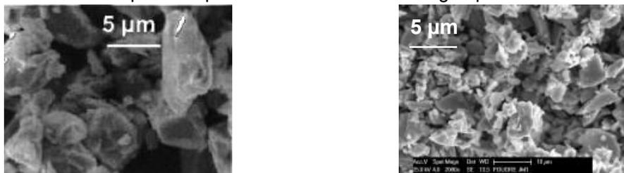
Figure 1 : Morphologie de la poudre MQ à gauche et CEA à droite (d50 = 5 µm).
