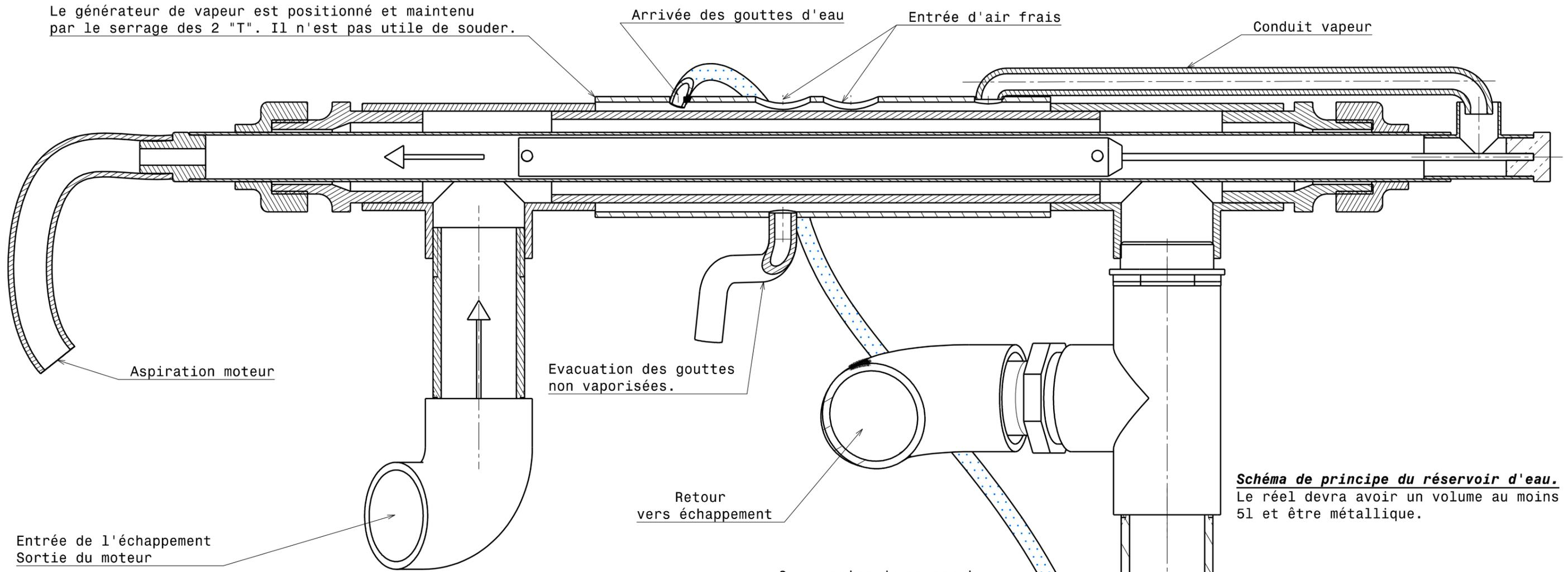
**Schéma de principe du réservoir d'eau.**
