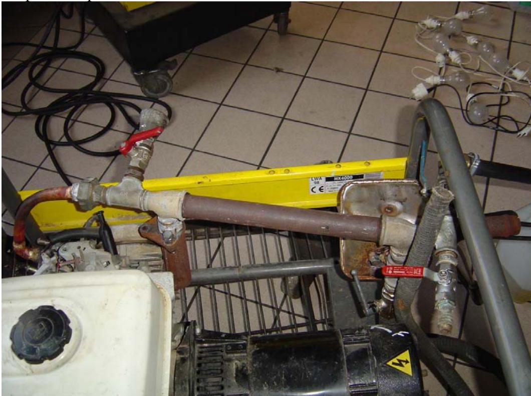
Le moteur est démarré en mettant de l'essence dans le carburateur d'origine. Pour être sûr de ne pas consommer de l'essence du réservoir du groupe, on vide le réservoir et on alimente le carbu avec une pipette.
