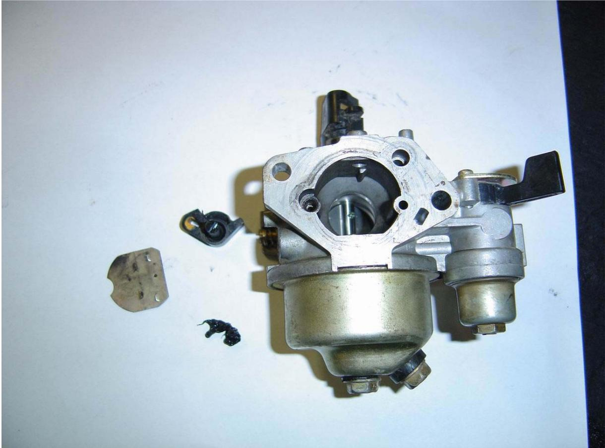
C'est assez normal car on envoyait le gaz Pantone dans un carburateur prévu pour être alimenté en air frais. Une pièce en métal va être réalisée.
